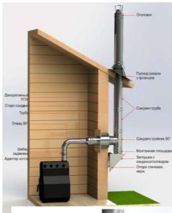
Рис.9 Двустенный вертикальный дымоход на внешней стороне стены с проходом через стену и кровлю при вертикальном выходном патрубке котла.
